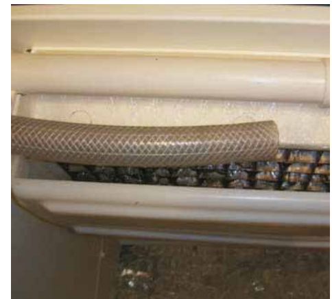
3 Monate nach Beginn der Verwendung RGF Eiseinheiten: Kein mikrobakterielles Wachstum mehr vorhanden
